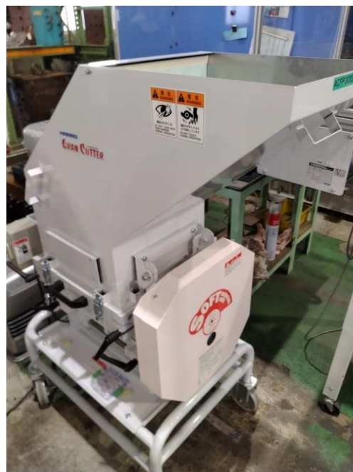
ゲート等の不要樹脂を再利用するための粒断機を導入(廃棄物削減)
